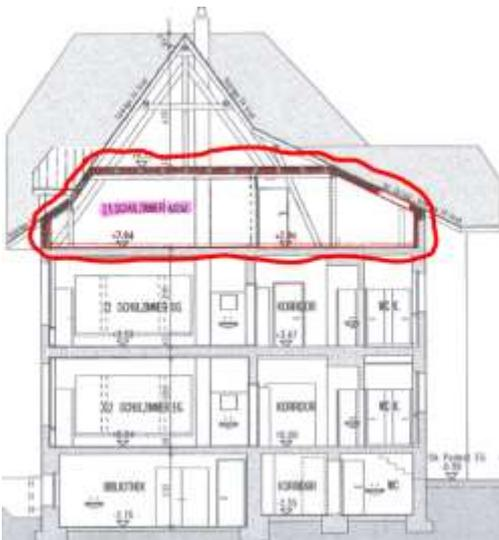
Der Estrich ist heute bis in den First offen. Die Kniewand muss über die Dachschräge bis auf Höhe Balkenlage isoliert und mit entsprechenden Verkleidungen versehen werden. Der nach Abschluss der Balkenlage im Kehlgeschoss verbleibende Raum wird als Ersatz-Abstellraum für den wegfallenden Estrich-Teil genutzt.
